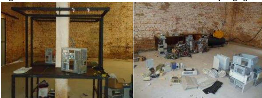
Na MG Tech, o material recebido é inicialmente acondicionado em caixas plásticas. Depois de segregado, os diferentes materiais são separados (abaixo), por tipo (plásticos, metais, placas de computador, vidro, etc). O material é então, armazenado, geralmente em big bag's, sendo acondicionados sobre paletes.
