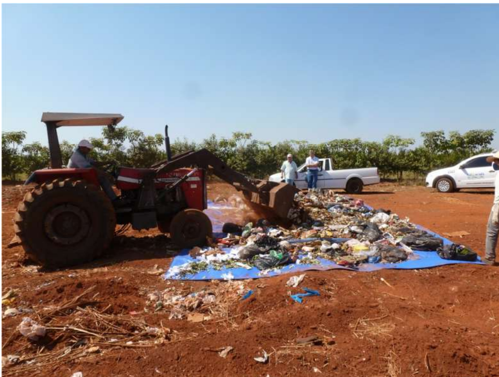
Figura 5. Detalhe da retroescavadeira criando a amostra de resíduos domiciliares para sua caracterização física
